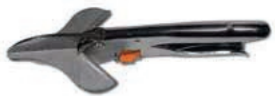
Gehrungsschere für Universalgummis Mit dieser Schere können Universalgummis und Flachleisten geschnitten werden.
